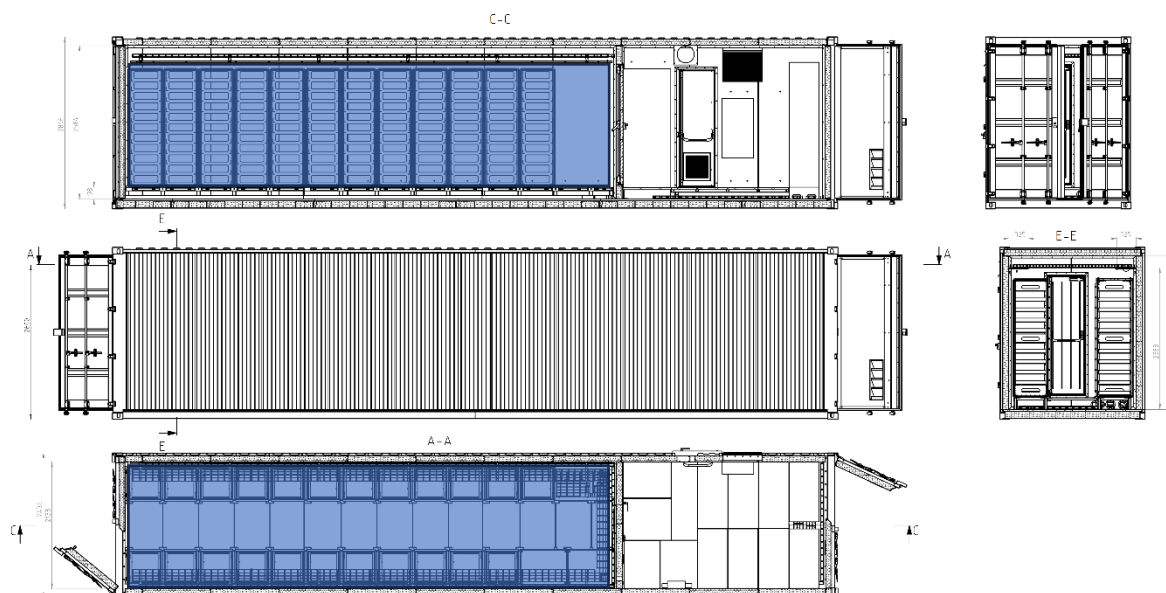
Obrázok č. 3 - 40ft kontajner - konštrukčné prevedenie (príklad)
